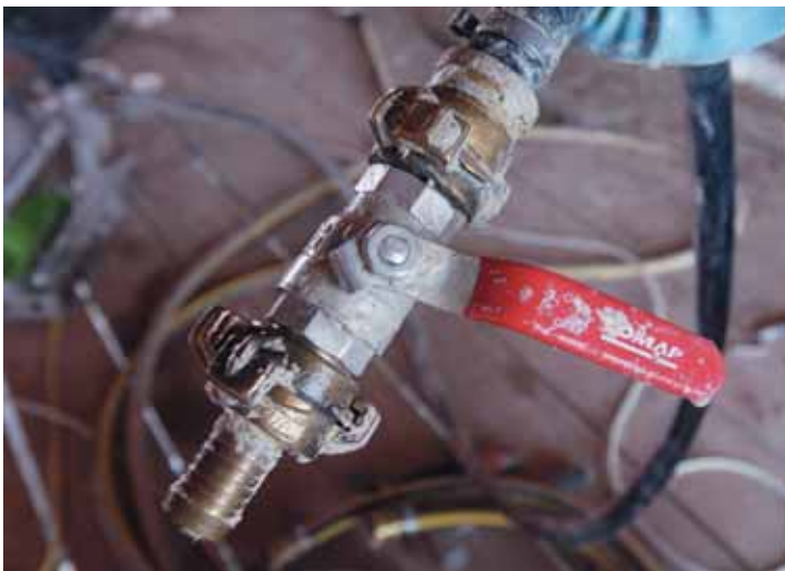
Met deze spuit wordt de mortel in de voegen gebracht.
